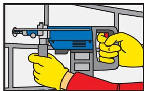
Taladre la perforación con el diámetro y profundidad correctos, usando un taladro roto-percutor y una broca de tungsteno.
