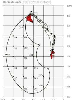
Las cargas indicadas en las tablas no superan el 87% de capacidad de elevación hidráulica o el 75% de carga de vuelco.
