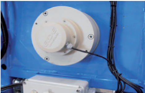
FRENO PARACAIDAS CON REARME AUTOMATICO OVER SPEED PARACHUTE, AUTO-RECOVERY SYSTEM FREIN PARACHUTE AVEC AUTO-RÉTABLISSEMENT
